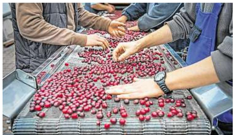
Hier sind ein gutes Auge und Erfahrung gefragt: Am Band der Sortiermaschine trennen Arbeiter die guten von den schlechten Beeren.
